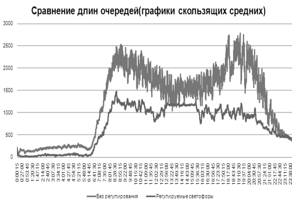
Рис. 3. Сравнение эффективности управляемых и неуправляемых светофоров в дорожной сети (динамика длин очередей)
